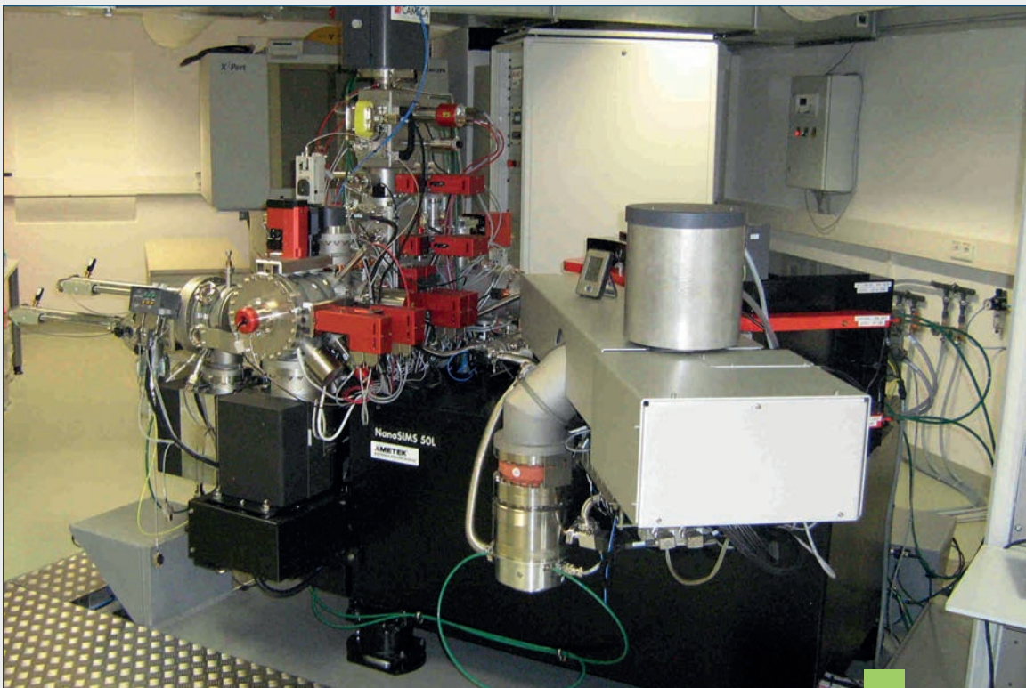
Abb. 1: Sekundärionenmassenspektrometer CAMECA NanoSIMS 50L. / Fig. 1: Secondary ion mass spectrometer CAMECA NanoSIMS 50L. (Foto: IOW)
