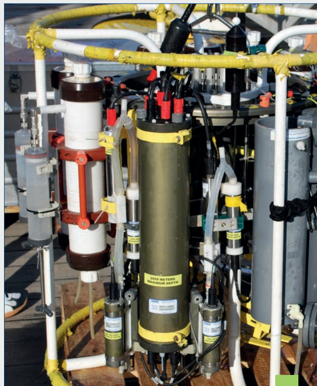
Abb. 2: AFIS im Einsatz an der CTD-Rosette. / Fig. 2: AFIS at the field fitted to a CTD-Unit. (Foto: IOW)
