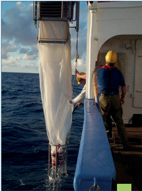
Abb. 2: Multischließnetz. / Fig. 2: Multi-Net Plankton Sampler. (Source: Waniek, IOW)
