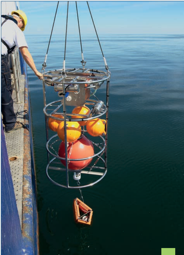
Abb. 2: Aussetzen der Unterwasser-Winde (oben) und der profilierenden Instrumenten-Plattform (unten). Winde und PIP werden zuerst ausgesetzt und treiben an der Wasseroberfläche, bis das Grundgewicht gefiert wird und Winde und PIP hinuntergezogen werden. / Fig. 2: Deployment of the underwater winch (top) and the profiling instrumentation platform (bottom). The winch and PIP are deployed upside down and float on the sea surface until the bottom weight is slipped and pulls winch and PIP down. (Foto: IOW)
